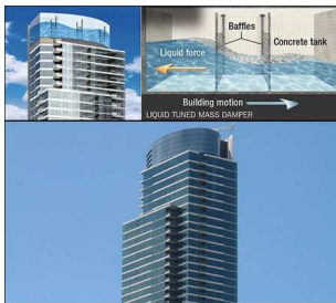
Figure 4 – Amortisseurs de balancement par TLMD (sources : web et A.F. Mensah et al Structural Safety 47 (2014) 78-86)
